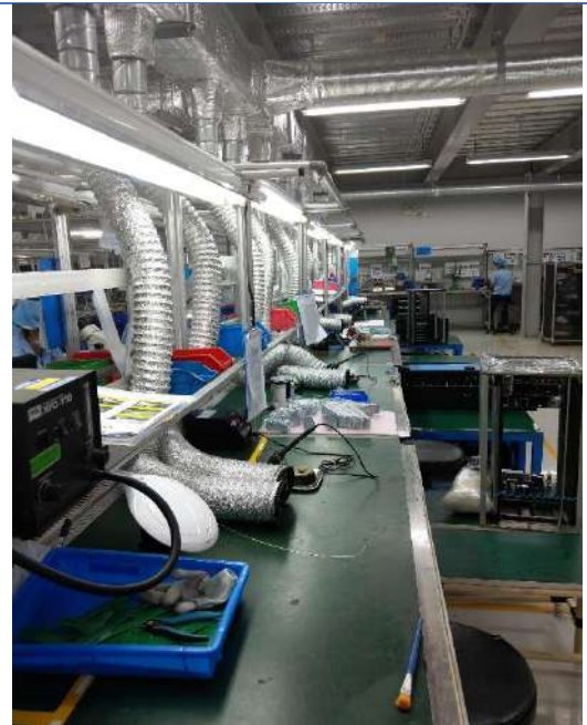
Hệ thống chụp hút và đường dẫn khí thải dây chuyền sản xuất và hàn bảng mạch bằng tay (DIP)
