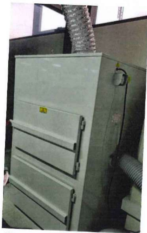
Hình 12 Tủ lọc bụi, thiết bị lọc bụi túi vải và khay thu hồi bụi máy cắt PCB R102L
