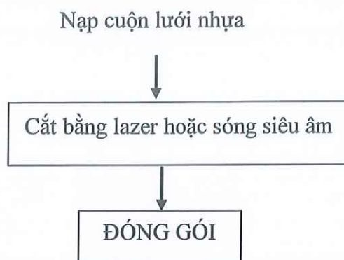
Hình 3. Quy trình công nghệ cắt lưới nhựa bằng tia laser, sóng siêu âm tại cơ sở
