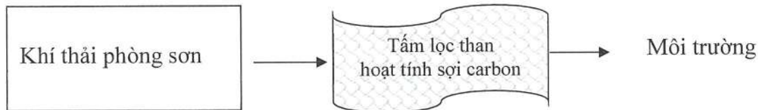
Hình 18. Sơ đồ xử lý khí thải dây chuyền sơn
