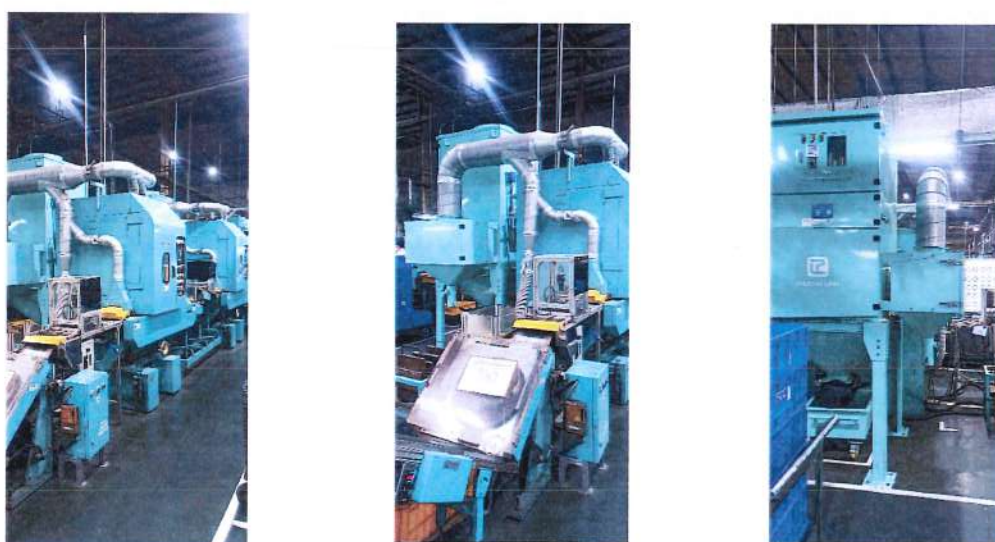
Hình 20: Một số hình ảnh hệ thống xử lý bụi, khí thải máy mài 2 mặt
