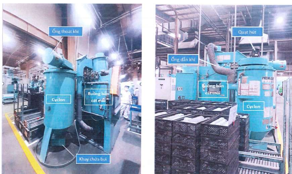
Hình 19: Một số hình ảnh của máy bắn mài tại Nhà máy
