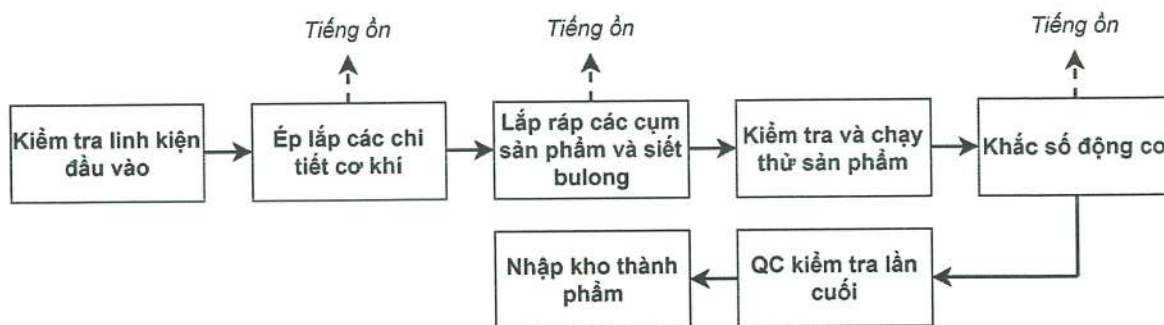
Hình 9: Quy trình công nghệ lắp ráp sản xuất sản phẩm động cơ xe, động cơ điện cho mô tô, xe máy và các máy móc, thiết bị, phụ tùng liên quan
