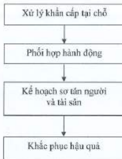
Hình 12: Sơ đồ mô phỏng công tác ứng phó sự cố rò rỉ, tràn đổ hóa chất
