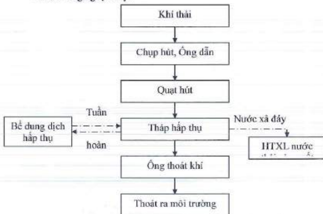
Bảng 16. Sơ đồ công nghệ xử lý khí thải các bể mạ
